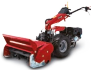
Trinciatutto TR80 (accessorio) TR80 flail mower (implement)
