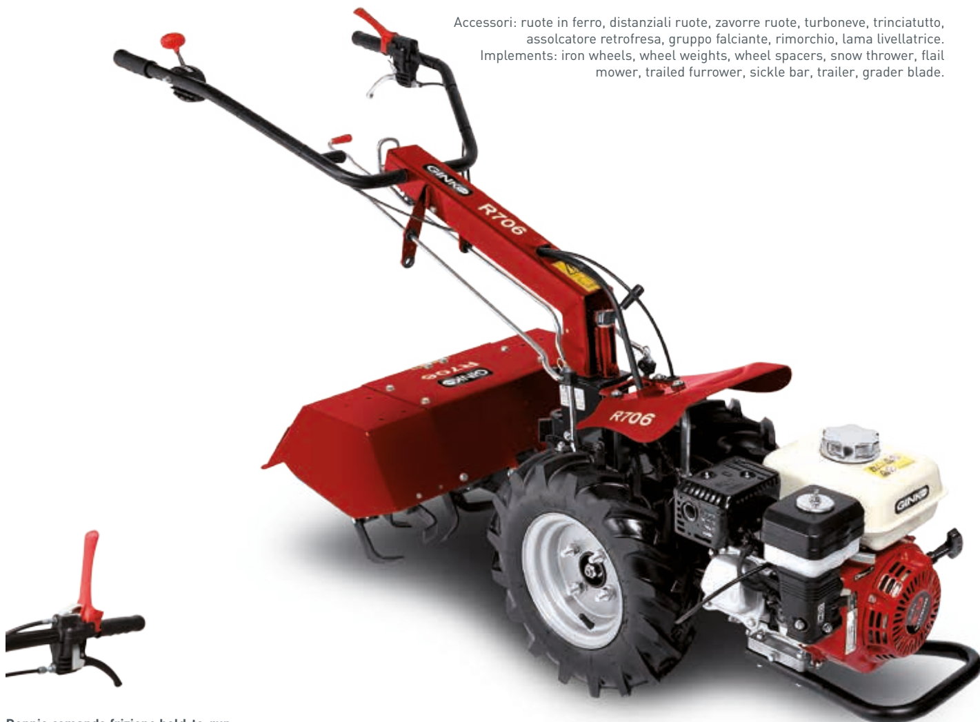
Doppio comando frizione hold-to-run Hold-to-run double clutch lever
