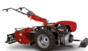
Fresa interrassassi con zavorra (accessorio) Stone burier (implement)
