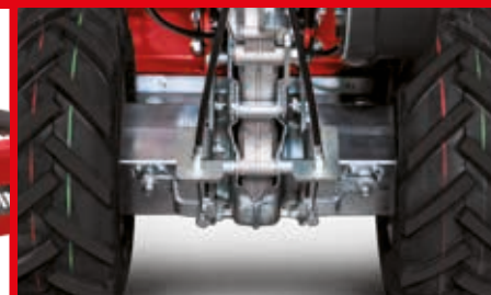
Asse ruote con sbloccaggi indipendenti Wheel axle Independent releases
