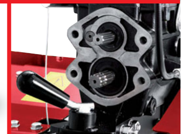
Presa di forza sincronizzata Presa di forza indipendente Synchronised power take off Independent power take-off
